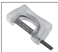
Figura 3: Lima insertada completamente en el sujetador
