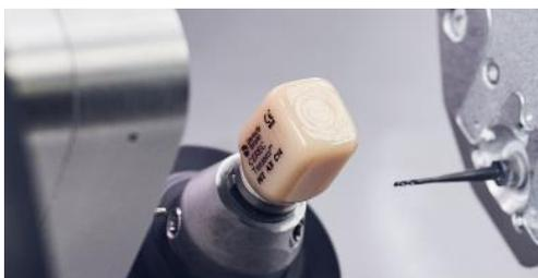
*Fig. 2: CEREC TESSERA es una cerámica avanzada de disilicato de litio para el flujo de trabajo CEREC que se puede procesar de forma excelente en el CEREC Primemill.*
