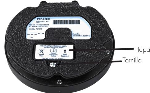
11.3 Retire el módulo interno del revestimiento exterior de la pieza de mano.
