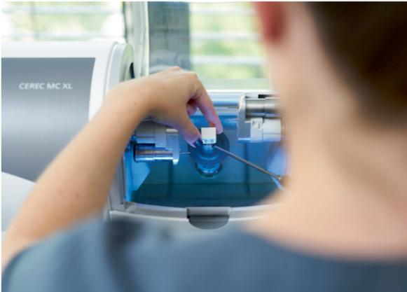
Danach wird die am Computer erstellte Restauration maschinell aus einem Keramikblock ausgeschliffen.
