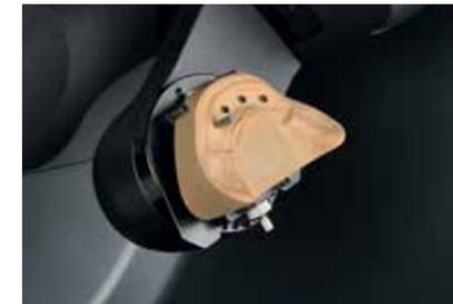
Mit der speziellen Scanstrategie für großspannige, direkt verschraubte Implantatarbeiten wird die Implantatposition hochgenau in Lage und Winkel bestimmt.
