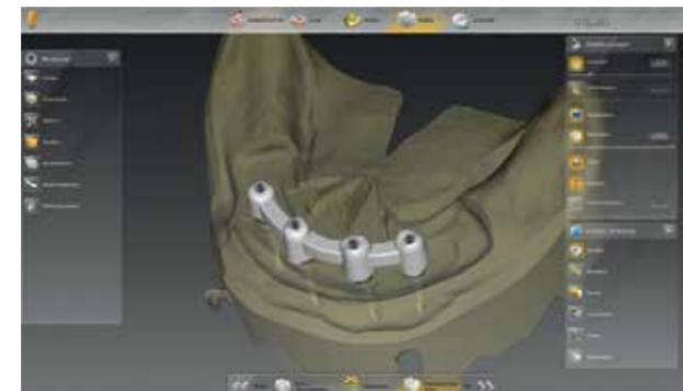
Standard-Stegformen für die Umsetzung in Zirkonoxid und Metall
