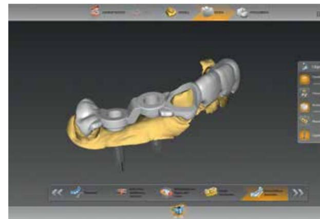
Die \*.cmg.dxd Planungsdatei wird in die inLab CAD Software zum Bohrschablonen-Design importiert\*. Die Bohrschablonenform kann individuell für beliebig große Spannweiten mit einem oder mehreren Bohrlöchern angepasst werden.
