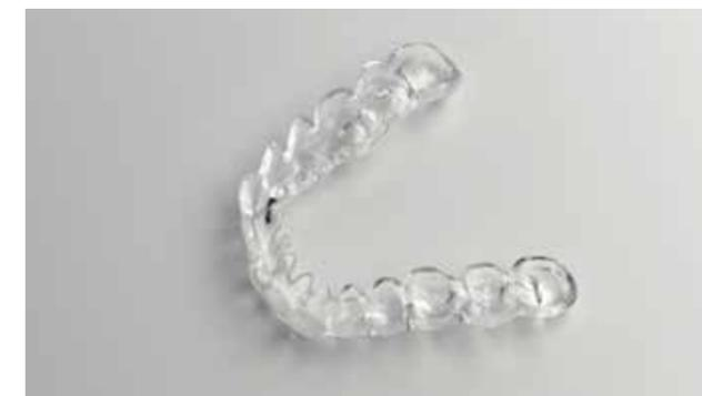
Die Schienenkonstruktion kann als STL-Datei exportiert und anschließend fräsend oder additiv hergestellt werden.
