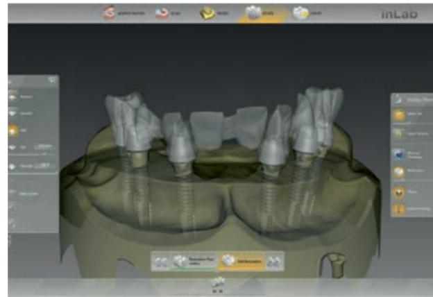
Direkt verschraubte Brücken und Stege auf Multi-Unit Abutments und Klebekappen
