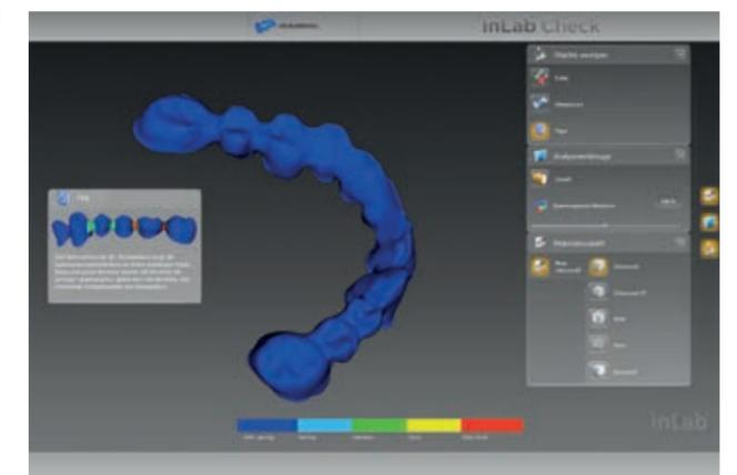
**inLab Check** zum Überprüfen der fertig konstruierten Restauration anhand einer FEM-Belastungsberechnung auf mögliche kritische Bereiche und auf Basis des für die Restauration gewählten Materials.
