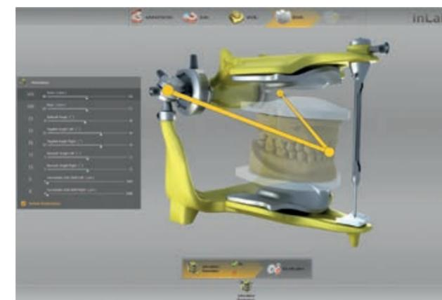
**Virtueller Artikulator** zur Visualisierung der kompletten Bewegungsbahnen und zur Ermittlung der statischen sowie dynamischen Kontaktflächen für die korrekte funktionelle Okklusion.
