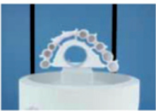
Правильное расположение на трегере для спекания
