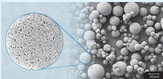
平均 0.6 $\mu$ m の微細なサブミクロンフィラーから噴霧顆粒法で得られたスフィアテック フィラーの表面性状。
