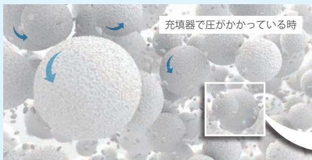
充填時に力を加えると、スフィアテック フィラーがボールが転がるような動きをし、わずかな力で賦形が可能です。
