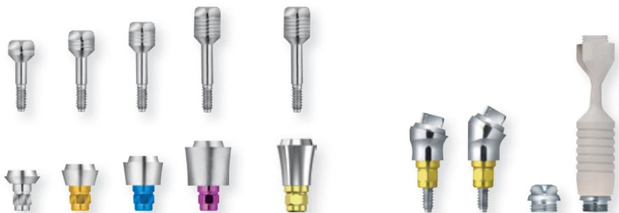
カラーコード化されたMPアバットメント (D 3.4 ~ 4.5) およびMPアバットメントスクリュー。スクリューヘッドに付けられているグループの数は、対応するアバットメントインサートの粘膜の高さを表しています。
