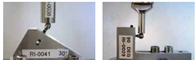
30°の軸外荷重方法 (ISO 14801:2007) とデンツプライシロナの90°の軸外荷重方法。
