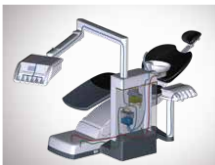
Sistemi di erogazione dell'acqua
