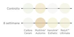
Test: Stabilità del colore. Tutti i cementi sono stati fotopolimerizzati. I campioni sono stati conservati in acqua distillata a 37 °C per 24 ore (almeno) e in acqua distillata a 60°C per 8 settimane. Fonte: Dati interni di Dentsply Sirona.
