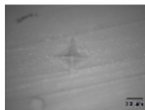
Ammaccatura dopo cottura a 760 °C per 2 minuti. La superficie è levigata e le fratture sigillate.
