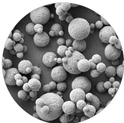
L'immagine al SEM mostra i riempitivi sferici SphereTEC® pre-polimerizzati. La forma e la dimensione ottimizzata dei riempitivi sferici assicurano una lavorabilità e una maneggevolezza "on-demand" del composito fluido.
