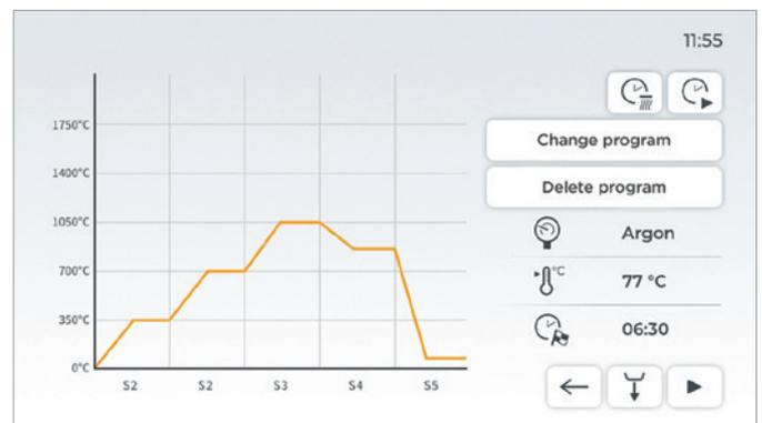
Vista del processo con la possibilità di attivare la pre-asciugatura, la regolazione dei parametri di processo, la programmazione delle funzioni di avvio automatico e la visualizzazione dei tempi di produzione.
