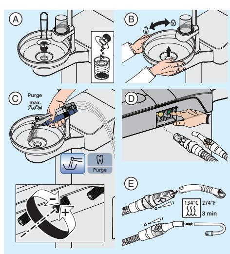
Nettoyer/désinfecter les circuits d'eau et le système d'aspiration
