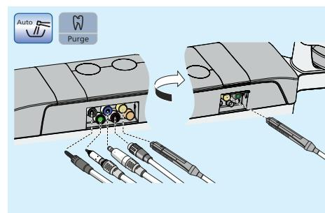
Déclencher le rinçage automatique des conduits d'eau (fonction AutoPurge)
