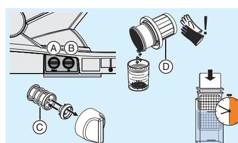
Remplacer les filtres (C) pour l'eau (A) et l'air (B)
