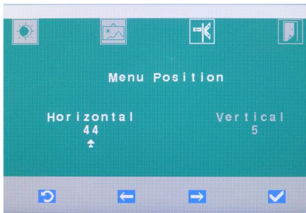
3. Régler la position horizontale et verticale du menu à l'aide des touches softkey [flèche gauche] et [flèche droite]. Confirmer avec le [crochet OK].
