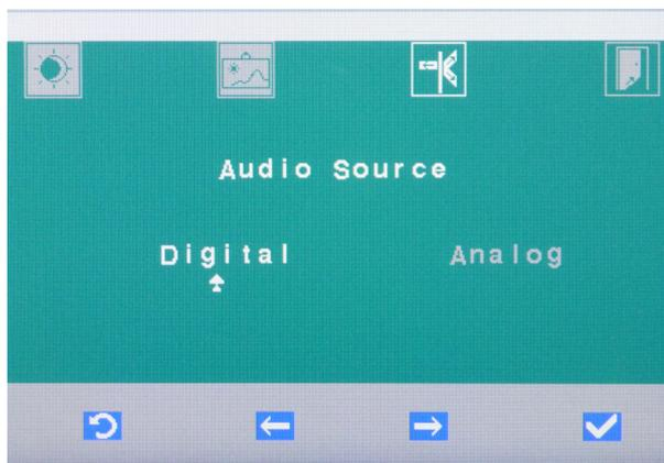
2. Sélectionner l'option „Digital“ (numérique) pour la transmission audio numérique par HDMI ou DisplayPort.
