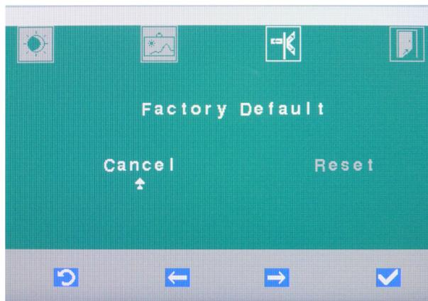
2. Sélectionner „Cancel“ (annuler), pour annuler la réinitialisation et conserver vos propres réglages. Si vous confirmez avec le [crochet OK], le menu à l'écran disparaît. Sélectionner „Reset“ (réinitialisation), pour ramener le moniteur aux réglages d'usine. Confirmer avec le [crochet OK].
