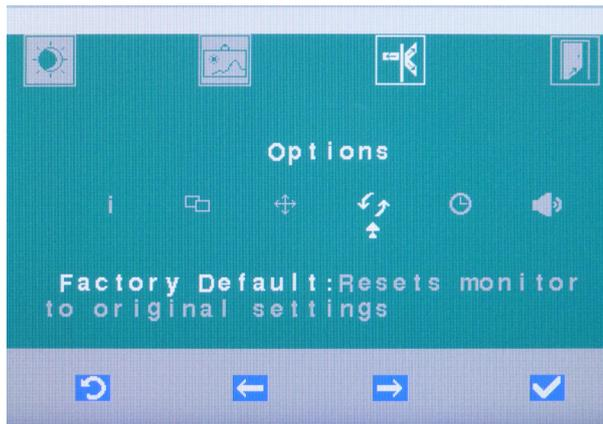
1. Sélectionner le réglage „Factory Default“ (configuration d'usine) et confirmer avec le [crochet OK].
