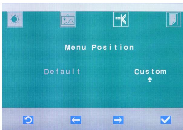
2. Sélectionner l'option „Default“ (configuration préalable) pour sélectionner la position de menu préconfigurée. Si vous confirmez avec le [crochet OK], le menu à l'écran s'affiche sur la position préconfigurée.
