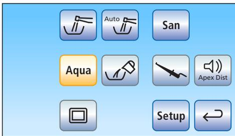
↳ Dans la boîte de sous-dialogue *Démarrage*, la touche *Aqua* devient orange. L'installation de désinfection est maintenant commutée sur l'alimentation en eau autonome.
