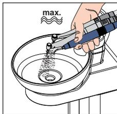
1. Prélevez les instruments à rincer et maintenez-les au-dessus de la cuvette du crachoir ou d'un récipient étanche présentant une capacité suffisante. Sur l'élément praticien CS : amenez les bras flexibles des instruments à rincer en position de travail, afin que le poids des cordons d'instruments les maintienne dans cette position.
