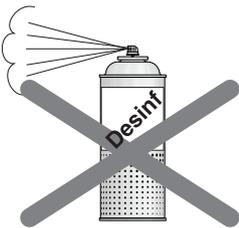
Ne pas pulvériser de liquides tels que des désinfectants dans les fentes d'aération ou dans les ouvertures des bras flexibles. Ceci peut provoquer des dysfonctionnements. Procédez uniquement à une désinfection par essuyage dans ces zones.
