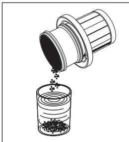
3. Versez l'excédent d'eau du récipient de sédimentation et collectez les résidus d'amalgame. Éliminez ces résidus dans les règles de l'art avec les résidus d'amalgame de la cuvette du crachoir et des cordons d'aspiration ; voir les sections « Nettoyage du collecteur d'or » [-> 265] et « Vider le tamis d'aspiration central » [-> 263]. Pour ce faire, contactez une société de recyclage certifiée.
