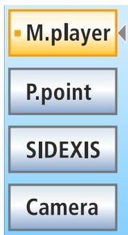
Les applications PC sont automatiquement lancées par le poste de traitement. Sur l'écran tactile, un carré orange devant le champ de l'application PC concernée signale si l'application est lancée sur le PC et si elle est opérationnelle. Tant que le carré orange n'apparaît pas, il n'est pas encore possible de communiquer avec l'application PC.
