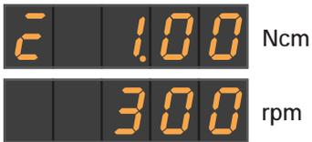
Pour le réglage de la vitesse, la fonction Endo étant activée, il est possible de changer l'afficheur EasyPad de sorte qu'il alterne entre les valeurs de couple et les valeurs de vitesse de rotation.
