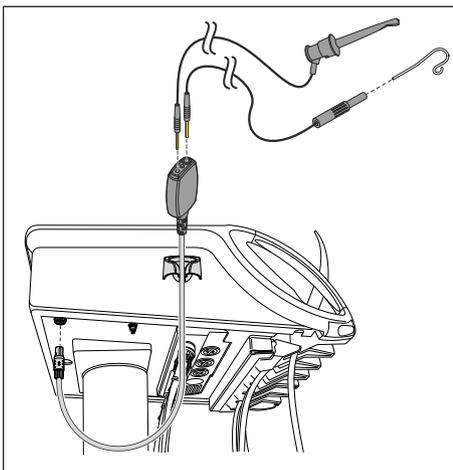
L'électrode pour tissu conjonctif et la pince pour lime se raccordent à la douille placée sous l'élément praticien par le biais de l'adaptateur pour localisateur d'apex.
