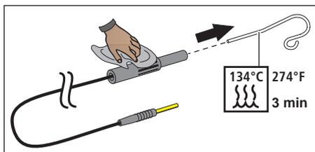
Débranchez l'électrode pour tissu conjonctif du câble de raccordement. Le crochet métallique peut être stérilisé, le câble de raccordement peut être désinfecté par essuyage.
