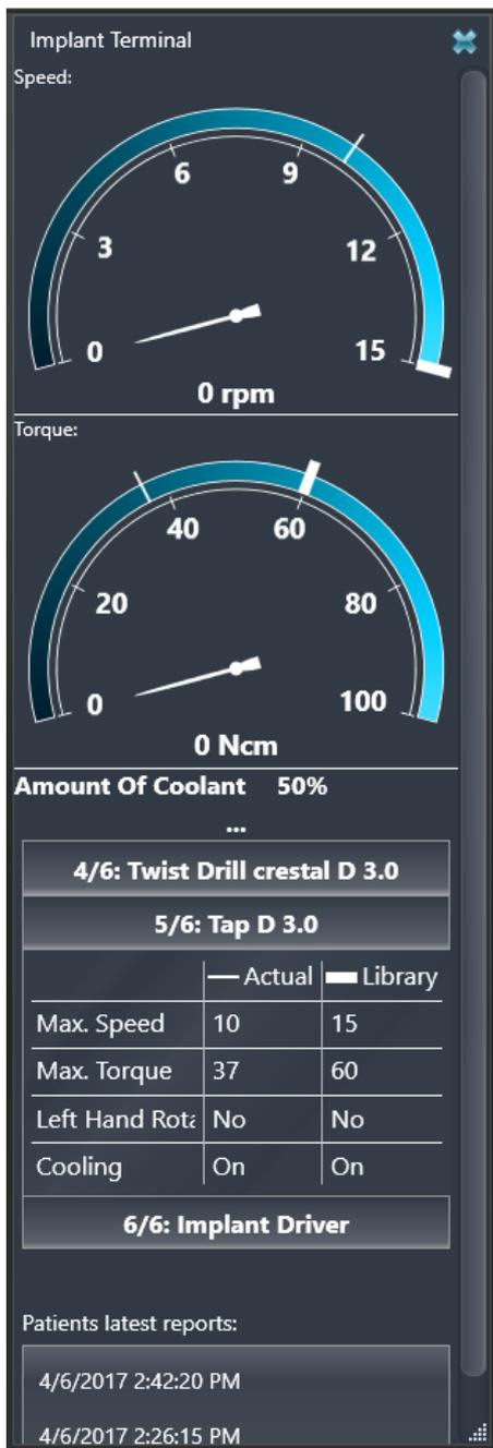
Les principaux paramètres du traitement d'implantologie peuvent être représentés en plus sur le moniteur Sivision. En outre, les valeurs de vitesse de rotation et de couple actuellement mesurées par le système de commande électronique sont transmises au moniteur. À partir des paramètres de traitement et des valeurs mesurées, il est possible de générer un rapport de traitement. Pour cela, Sidexis 4 ainsi que les Dental Unit Plugins doivent avoir été installés sur le PC.
