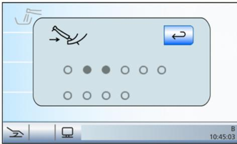
3. Reposez les instruments prélevés dans leur support. Les instruments non reposés sont signalés par un cercle gris plein sur l'écran tactile.
