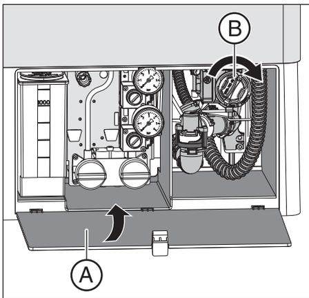
5. Remontez l'élément filtrant dans le boîtier de filtre. Tournez l'élément filtrant **B** dans le sens des aiguilles d'une montre.
