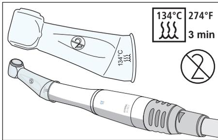
La gaine isolante en silicone est un article à usage unique. Elle doit être remplacée après chaque patient. La gaine isolante en silicone doit être stérilisée avant d'être utilisée.
