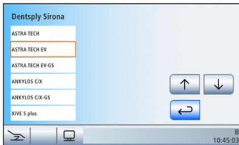
2. Sélectionnez un système d'implants. Les touches ↑ et ↓ permettent de naviguer dans la liste. Les champs déjà colorés en orange peuvent être désélectionnés en les touchant une nouvelle fois.
