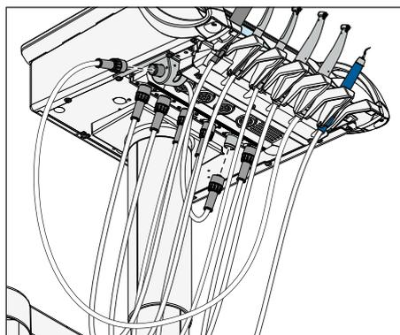
1. Si votre poste de traitement est équipé d'une cuvette de crachoir, actionnez le rinçage circulaire pendant au moins une minute. Ceci rince les conduites d'alimentation en eau.
