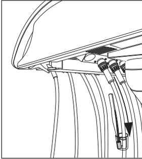
A l'extrémité du cordon côté appareil, une petite quantité d'huile de turbine est dégagée avec l'air refoulé. L'huile est absorbée par le rouleau de coton dans le récipient transparent.
