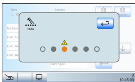
Les options cliniques ne peuvent être utilisées qu'en liaison avec les moteurs sans collecteurs du fait de leur possibilité de réglage précis. L'apparition de l'affichage suivant (voir ci-contre) après l'activation de l'option Clinique signale que les instruments dynamiques repérés par un triangle de signalisation ne conviennent pas pour des applications cliniques. En pareil cas, veuillez vous adresser à votre dépôt dentaire.
