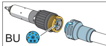
Le moteur BL est conçu pour commander directement les pièces-à-main T1 Classic. Pour pouvoir utiliser par ex. les pièces-à-main T1 Line, on devra intercaler, soit l'adaptateur Basic (mesure de l'apex et non pas spray), soit l'adaptateur ISO (spray et non pas mesure de l'apex).
