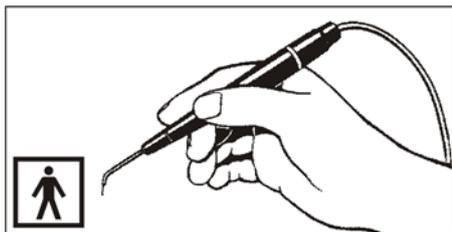
La pièce-à-main bistouri électrique permet d'effectuer l'électrotomie (coupe), la coagulation et la dessiccation en technique monoterminal. Vous disposez à cet effet de différentes électrodes.
