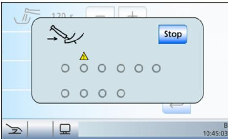
Si le message *Poser les instruments* apparaît après le démarrage de la fonction Purge, l'unité de traitement a détecté que tous les instruments ne sont pas en place dans leur repose instruments.
