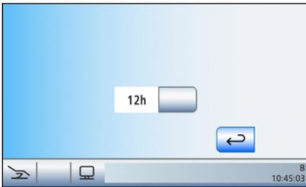
↳ Lorsque la synchronisation d'horloge est activée, les boutons de réglage de la date et de l'heure sont masqués dans la boîte de dialogue de configuration.
