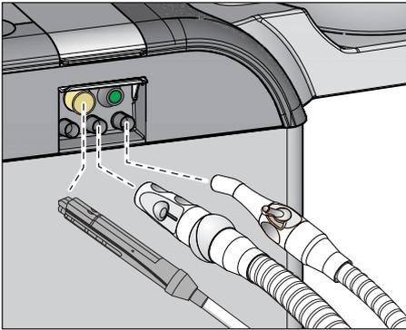
4. Coté élément assistante : insérez le corps de vanne de la Sprayvit M sur l'adaptateur du groupe d'eau. Réglez le courant d'aspiration maximal sur les pièces-à-main d'aspiration et connectez-les ensuite sur la prise.
