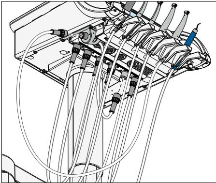
4. Si le poste de traitement est équipé d'un raccord moteur latéral, celui-ci doit être intégré au processus d'assainissement. Pour cela, raccordez le flexible du raccord moteur latéral au raccord de l'élément praticien d'un instrument comportant un conduit d'eau. Ensuite, raccordez le flexible de l'instrument comportant un conduit d'eau au raccord moteur latéral.
