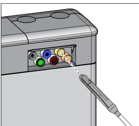
1. Sortez la Sprayvit M du porte-instruments sur l'élément praticien. Retirez les gaines Sprayvit M du corps de vanne et raccordez le corps de vanne à l'adaptateur du groupe d'eau (sur la Sprayvit M: levier de vanne vers le haut, bouton d'arrêt vers le bas).
