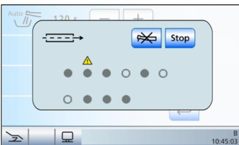
1. Contrôlez le débit d'eau des instruments repérés par un triangle d'avertissement sur l'écran tactile. Réglez le débit d'eau maximal sur les instruments. Tous les instruments doivent rester enfilés dans le groupe d'eau.
