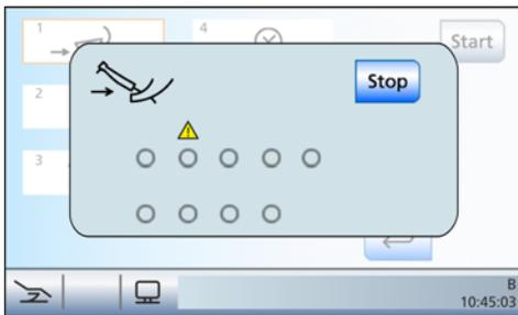
Si le message *Poser les instruments* apparaît après le démarrage de l'assainissement, le poste de traitement a détecté que tous les instruments ne sont pas en place dans le repose-instruments.
