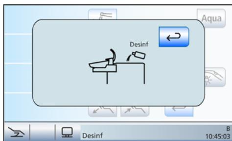
La commutation du système de désinfection sur le fonctionnement avec le réseau public d'alimentation en eau potable s'effectue de la même manière que la commutation sur l'alimentation en eau autonome. À la place de *Faire l'appoint d'eau*, l'écran tactile affiche *Faire l'appoint de produit de désinfection des conduits d'eau*.
