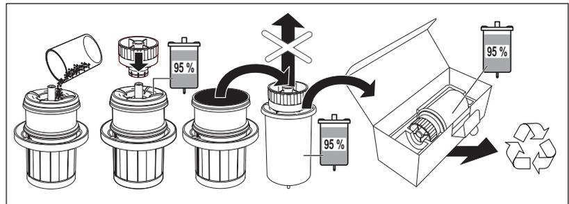
3. Eliminez les résidus d'amalgame collectés du crachoir et des cordons d'aspiration dans le rotor d'amalgame, voir « Nettoyage du collecteur d'or » [→ 259] et « Nettoyage et désinfection des cordons d'aspiration » [→ 256]. Versez les résidus d'amalgame dans le rotor d'amalgame.
