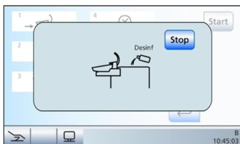
Si le message *Desinf* apparaît après le démarrage de l'assainissement, le niveau de produit de désinfection des conduits d'eau dans le réservoir du groupe d'eau n'est pas suffisant pour l'assainissement du poste de traitement. La procédure d'assainissement ne peut pas démarrer si la quantité de produit est insuffisante ; voir « Faire l'appoint de produit de désinfection des conduits d'eau » [→ 262].
