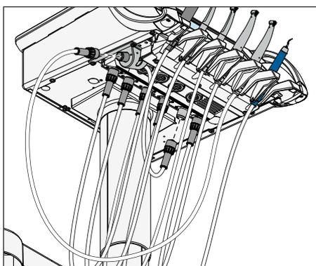
5. Si le poste de traitement est équipé d'un raccord moteur latéral, celui-ci doit être intégré au processus d'assainissement. Pour cela, raccordez le flexible du raccord moteur latéral au raccord de l'élément praticien d'un instrument comportant un conduit d'eau. Ensuite, raccordez le flexible de l'instrument comportant un conduit d'eau au raccord moteur latéral.
