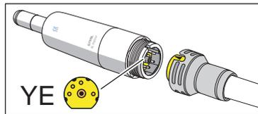
Le moteur BL Implant est spécialement conçu pour une utilisation chirurgicale. Il ne comporte donc pas de passage d'air/d'eau (spray) ni de lumière d'instrument. Il dispose d'un couple très élevé.
