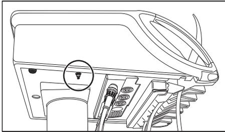
Le débit du spray est pré-réglé en usine. Il est toutefois possible de le modifier en agissant sur une vis de réglage sous l'élément praticien. Ce réglage s'applique alors à tous les instruments dynamiques.
