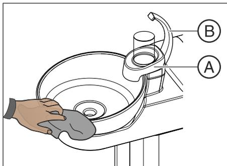
La cuvette du crachoir ainsi que le porte-verre **A** et le bec de remplissage **B** peuvent être désinfectés par pulvérisation ou par essuyage.
