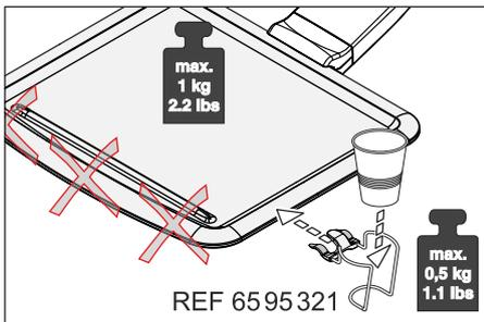
Il est possible de fixer un porte-verre sur la tablette pour recueillir les déchets. Celui-ci est adapté aux verres jetables d'une capacité de 0,2 litre.
