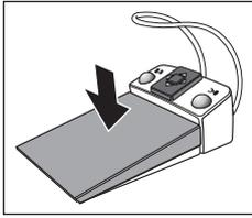
Dans le Setup du poste de traitement, il est possible de configurer la possibilité de mettre au point l'image de la caméra par la pédale, voir « Activer/désactiver la mise au point de la caméra intra-orale via la pédale » [→ 219]. Lorsque cette fonction est activée, il faut appuyer à fond sur la pédale jusqu'à la butée pour basculer entre l'image live et l'image fixe.
