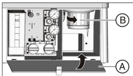
3. Maintenez la partie inférieure de la centrifugeuse d'amalgame **B** de sorte que les ergots de verrouillage de la monture à baïonnette soient perpendiculaires à l'unité d'eau. Tournez la partie inférieure de la centrifugeuse d'amalgame **B** dans la centrifugeuse d'amalgame dans le sens des aiguilles d'une montre.
