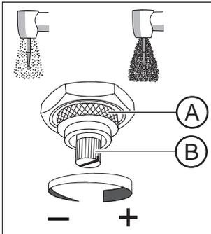
1. Dévissez la bague **A** dans le sens inverse des aiguilles d'une montre.
