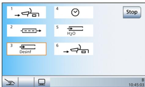
L'eau est pompée du réservoir d'eau du groupe d'eau par l'intermédiaire du système de remplissage du verre. Puis, le réservoir d'eau se remplit automatiquement de produit pur de désinfection des conduits d'eau. Les cordons des instruments et de la Sprayvit M et le système de remplissage du verre sont alors rincés avec le produit. Les tuyaux d'aspiration sont nettoyés.
