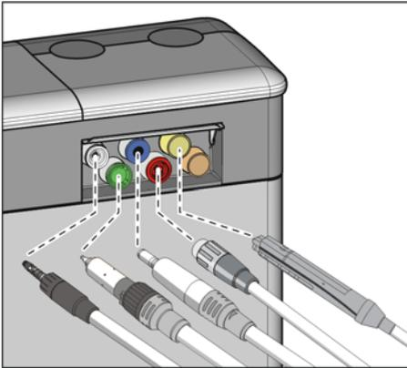
3. Côté élément praticien : insérez les accouplements de tous les instruments comportant des conduits d'eau dans les adaptateurs du groupe d'eau (sur Sprayvit M : levier de vanne vers le haut, bouton d'arrêt vers le bas).
