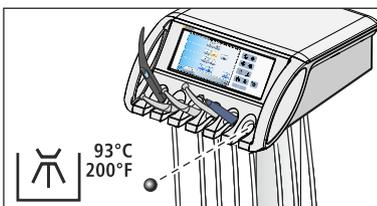
Une bille d'obturation qui pourrait se trouver dans un logement inoccupé du repose-instruments peut être simplement poussée par l'arrière pour permettre le nettoyage ou la thermodésinfection.
