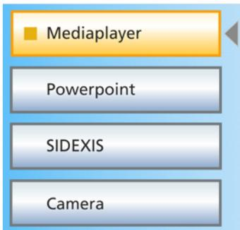
Les applications PC sont automatiquement lancées par le poste de traitement. Sur l'écran tactile, un carré orange devant le champ de l'application PC considérée signale si l'application est lancée sur le PC et si elle est opérationnelle. Tant que le carré orange n'apparaît pas, il n'est pas encore possible de communiquer avec l'application PC.
