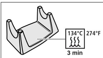
L'élément praticien peut ultérieurement être doté d'un raccord moteur latéral. Ce dernier est livré avec un couvercle de protection stérilisable. Il est vissé sur le raccord moteur latéral pour le protéger des salissures lorsque le raccord n'est connecté à aucun flexible d'instruments.
