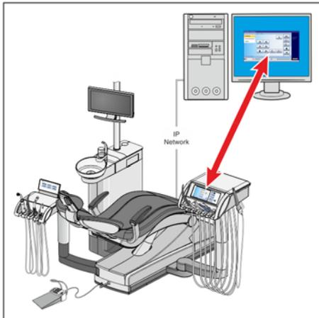
Il est possible de relier le poste de traitement à un PC avec un câble Ethernet. L'application PC Sivation Connect et/ou Siucom Plus permet d'établir la communication entre le poste de traitement et le PC. Siucom Plus est nécessaire pour la commande du PC. Il est ainsi possible de piloter directement le PC depuis l'écran tactile et, en liaison avec la caméra intra-orale SiroCam AF+, également depuis la pédale du poste de traitement.
