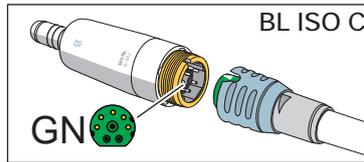
Le moteur BL ISO C est directement équipé d'un raccord ISO. Cela permet d'utiliser par ex. les pièces-à-main T1 Line sans adaptateur.
