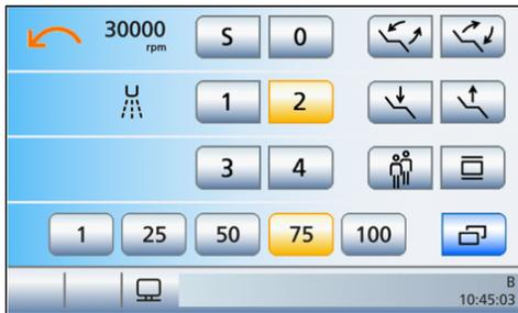
➤ Pour la rotation à gauche : déplacez la plaque de commande bidirectionnelle vers la gauche.
