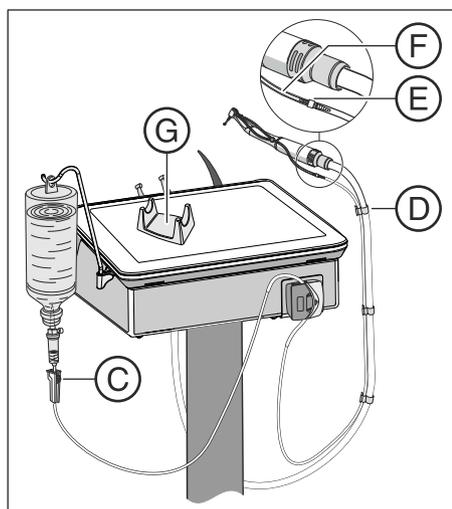
3. Enfoncez l'extrémité courte du flexible avec la canule à travers le bouchon de la bouteille de NaCl. Le régulateur situé dans la bride de serrage **C** doit être entièrement ouvert (molette de régulation dans la position la plus haute).
