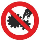
Signification : prudence, risque de blessure des doigts en contact avec les pièces en mouvement
