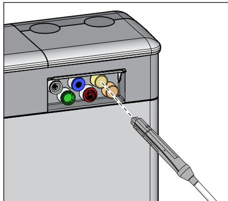
1. Enfichez le corps de la vanne de la Sprayvit M dans l'adaptateur du groupe d'eau sur l'élément praticien, comme décrit précédemment. Attendez que l'eau arrête de s'écouler de la Sprayvit M.
