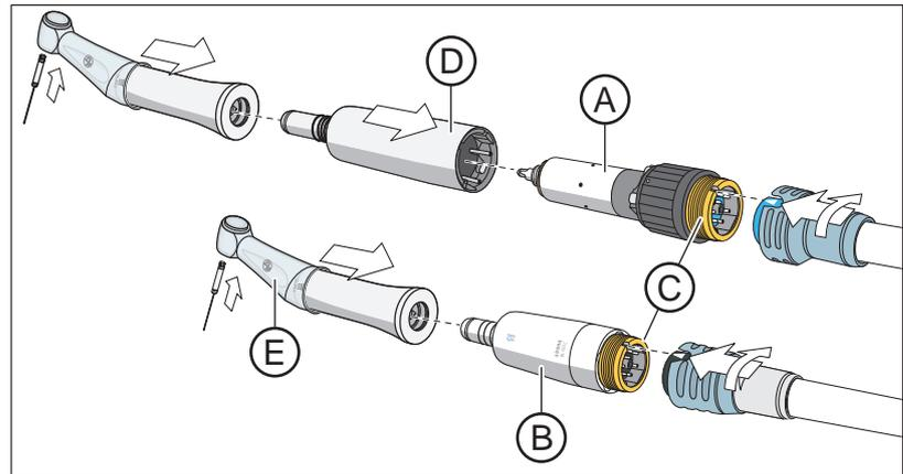
Pour le traitement endodontique avec Apexlocator, les contre-angles Endo 6:1 (à partir du numéro de série 6407/juillet 2010) ou Endo 6 L de Dentsply Sirona sont nécessaires pour utiliser la fonction Thérapie. Lors de l'utilisation de l'ApexLocator dans la boîte de dialogue du moteur (sans limiteur de couple) la pièce à main SiroNiTi Apex de Dentsply Sirona est nécessaire.
