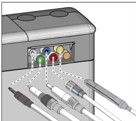
3. Côté élément praticien : insérez les accouplements de tous les instruments comportant des conduits d'eau dans les adaptateurs sur le groupe d'eau (sur Sprayvit M : culbuteur vers le haut, bouton vers le bas).
