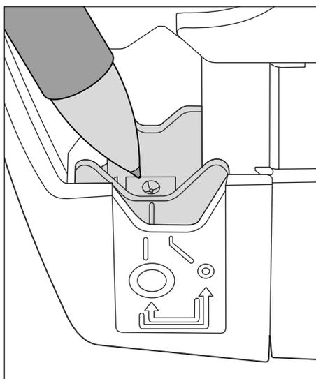
La pompe NaCl présente deux réglages pour des cordons de pompes péristaltiques de différents diamètres. Le réglage large doit être utilisé pour les cordons de pompes péristaltiques de Dentsply Sirona. Ceci permet d'obtenir un débit optimal. La pompe NaCl sortant de l'usine est donc paramétrée avec le réglage large.
