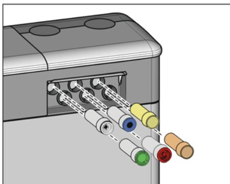
2. Si aucun adaptateur n'est encore en place sur les raccords du groupe d'eau, insérez-les dans les raccords jusqu'à la butée. Du côté de l'élément praticien, les Sprayvit Madaptateurs de la peuvent être insérés uniquement sur les deux raccords de droite, la nervure de guidage étant dirigée vers le haut. Du côté de l'élément assistante, il est également nécessaire d'insérer un Sprayvit Madaptateur de. Les adaptateurs restent enfoncés dans le groupe d'eau.
