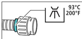
Le poste de traitement est équipé en standard de flexibles non thermodésinfectables. Des flexibles thermodésinfectables sont proposés dans le programme d'accessoires spéciaux. Ces derniers sont repérés par une bague de couleur turquoise.
