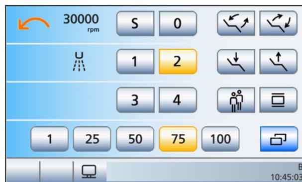
Mode Boîte de démarrage EasyMode avec fonctions d'instruments du moteur
