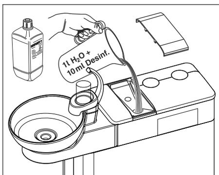
2. Mélangez 100 volumes d'eau distillée avec 1 volume de produit de désinfection des conduits d'eau (soit 1 L d'eau pour 10 ml de produit), puis versez le mélange dans le réservoir de désinfectant du groupe d'eau. Le réservoir a une capacité d'environ 1,3 litre. Il est rempli lorsque la surface de l'eau est visible au niveau de la crépine de l'entonnoir de remplissage.
