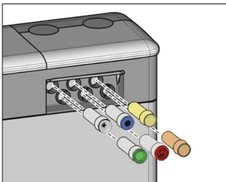
2. Si aucun adaptateur n'est encore en place sur les raccords du groupe d'eau, insérez-les dans les raccords jusqu'à la butée. Du côté de l'élément praticien, les Sprayvit Madaptateurs de la peuvent être insérés uniquement sur les deux raccords de droite, la nervure de guidage étant dirigée vers le haut. Du côté de l'élément assistante, il est également nécessaire d'insérer un adaptateur de Sprayvit M. Les adaptateurs restent enfichés dans le groupe d'eau.
