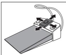
Pour permettre la commande par curseur, la pédale dispose d'une plaque de commande bidirectionnelle qui peut être actionnée dans quatre directions.
