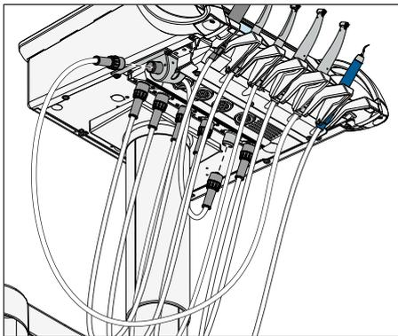
1. Si votre poste de traitement est équipé d'une cuvette de crachoir, actionnez le rinçage circulaire pendant au moins une minute. Ceci rince les conduites d'alimentation en eau.
