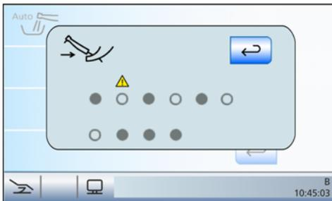
Si certains instruments comportant des conduits d'eau ne sont pas rincés, ceci est signalé sur l'écran tactile par un triangle d'avertissement.
