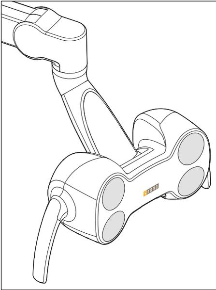
La lampe scialytique est montée sur un bras-support à articulations multiples. Elle se règle facilement sur le champ de travail à l'aide des poignées. Les freins intégrés dans le bras-support maintiennent la lampe scialytique dans la position réglée.
