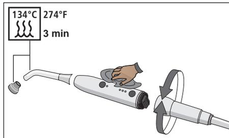
1. Débranchez le câble de raccordement de la Mini L.E.D. en faisant tourner la pièce-à-main.
