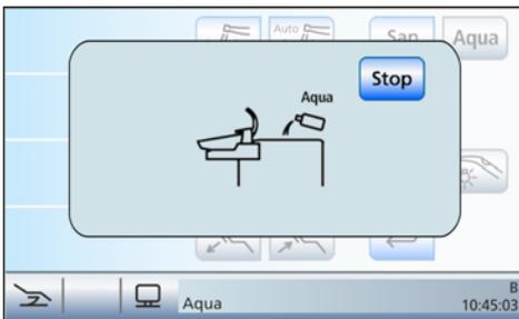
Si le message *Faire l'appoint d'eau* apparaît après le démarrage de la fonction de purge, la quantité d'eau dans le réservoir de désinfectant du groupe d'eau ne suffit pas pour assurer le rinçage des conduits d'eau. Il n'est pas possible de démarrer la fonction de purge lorsque la quantité d'eau est insuffisante.
