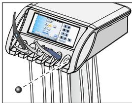
L'élément praticien est fourni avec une bille d'obturation au cas où un repose-instruments devait rester inoccupé.
