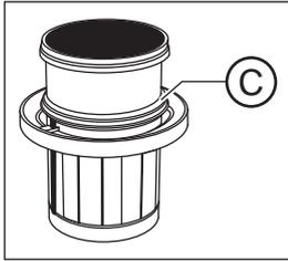
1. Graissez le joint torique **C** sur le récipient de sédimentation. En ce qui concerne les graisses, voir « Produits d'entretien, de nettoyage et de désinfection » [-> 225].
