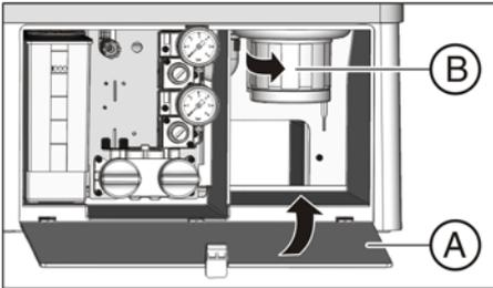
2. Maintenez le récipient de sédimentation **B** de sorte que les ergots de verrouillage de la monture à baïonnette soient perpendiculaires au groupe d'eau. Tournez le récipient de sédimentation **B** dans le sens des aiguilles d'une montre.
