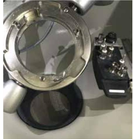
Entspricht dem Vorgänger des Sieb Nr. 1 für Nassbearbeitungsprozesse. Dieses Sieb sollte nicht mehr verwendet werden. Alle inLab MC X5 Seriennummern < 401581 wurden über den Fachhandel mit Sieb Nr. 1 nachbeliefert. Bitte ggf. den Fachhandel kontaktieren.
