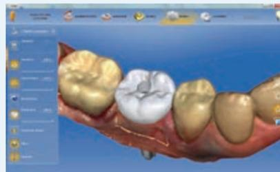
**9** Es erfolgt die Konstruktion einer direkt verschraubten Krone als Provisorium aus Telio CAD, Ivoclar. Das Emergenzprofil wird an die individuellen Bedürfnisse angepasst.
