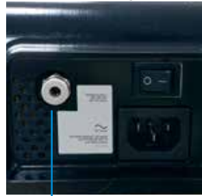
Pulse el anillo para liberar el tubo de suministro de agua.
