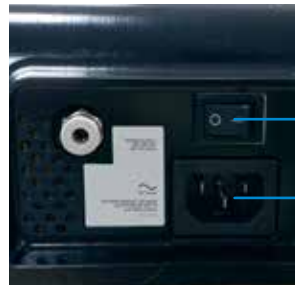
Interruptor de alimentación principal Entrada de alimentación
