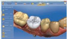
9 Se realiza la construcción de una corona directamente atornillada a modo de implante provisional de Telio CAD, Ivoclar. El perfil emergente se adapta a las necesidades individuales.
